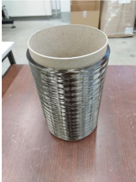
Abbildung 3: Basaltfaser in der typischen Lieferform als Roving (Multifilamentgarn)
