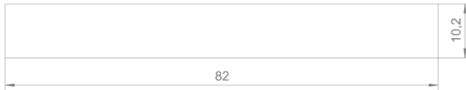
Abbildung 7: Normprüfkörper für Biegeprüfung nach DIN EN ISO 178 ([14], S. 4)
