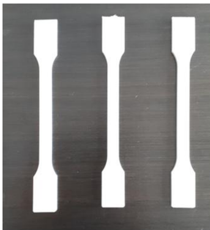
Abbildung 6: Zugprüfkörper PA6; links: vor der Prüfung; rechts: zerstörte Prüfkörper nach Prüfung
