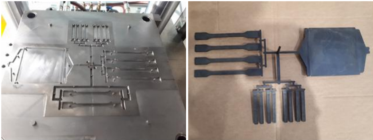
Abbildung 4: links: Mehrzweckwerkzeug; rechts: Probekörperspritzguss
